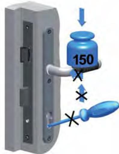
Der Drücker darf nur im normalen Drehsinn belastet werden. In Betätigungsrichtung darf auf den Drücker maximal nur eine Kraft von 150N aufgebracht werden.
