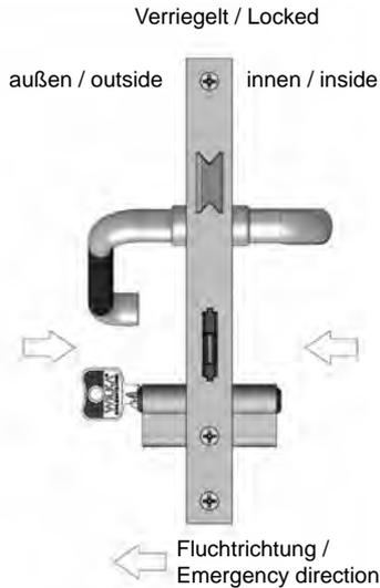
Durch Betätigung des Drückers Durchgang immer möglich.
