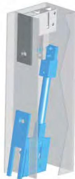
Gegenkasten und Umlenkschloss wie dargestellt aufstecken.
