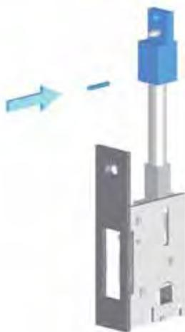
Treibriegelstange und Verbindungselement mit Spannhülse
